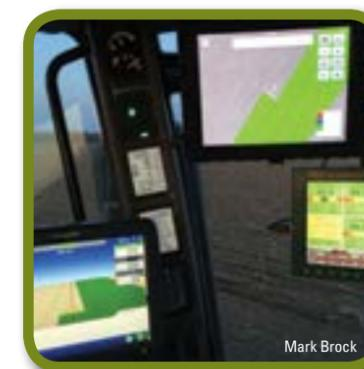
Système de GPS installé sur un tracteur
